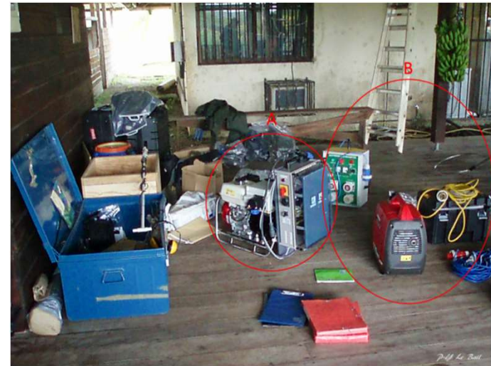
Matériel utilisé pour la campagne de pêche électrique dans les petites masses d'eau de Guyane française. A : l'appareil français. B : l'appareil anglais. Crédit : Pierre-Yves Le Bail (INRA)
