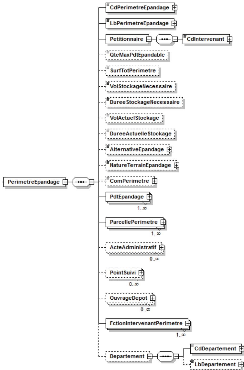
Figure 9. Diagramme représentatif de l'élément <PerimetreEpannage>
