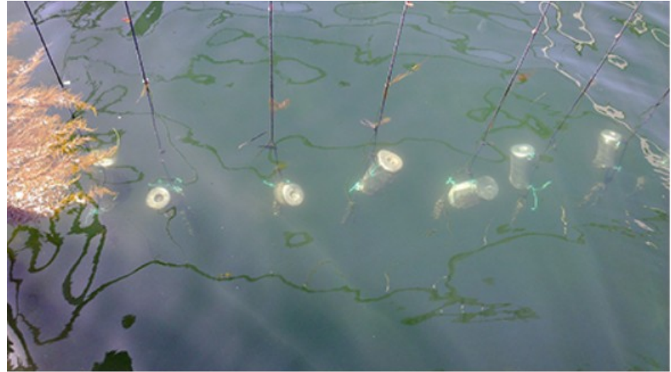
Exposition des échantillonneurs en eaux de surface (Essai Inter laboratoire AQUAREF 2011).© BRGM
